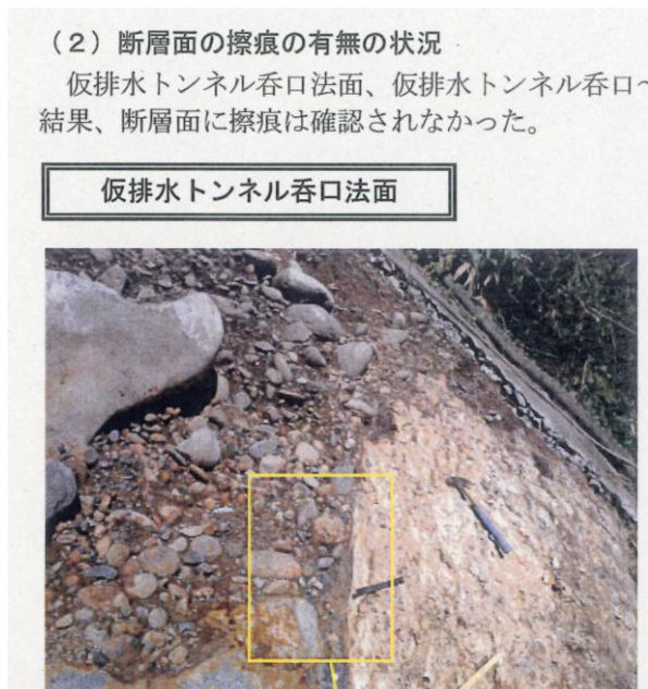
写真 7. 3・14 報告書は、呑口露頭右端部 (写真 6 部分) で、「砂礫層 SG 4 層が F-V 断層と接する」と記載している (右の写真は左の拡大)
