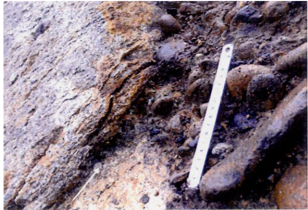
写真 3.4.2.6 砂礫層と基盤岩の境界に沿って 破砕は認められない。
